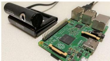
撮影にはRaspberryPiと、それにUSB接続したWebカメラを使用し、**動体検出**を利用して撮影した。
