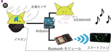
サウンドロップスは雨が 2 本の電極の間に雨が当たることで回路をつなげることができ、電子音楽を出力します。Bluetooth モジュールの通信機能を使い、Arduino とスマートフォンを連携させることができます。また LED が光りその光を受け取ることで、SOUNDHAIR を光らせることができます。
