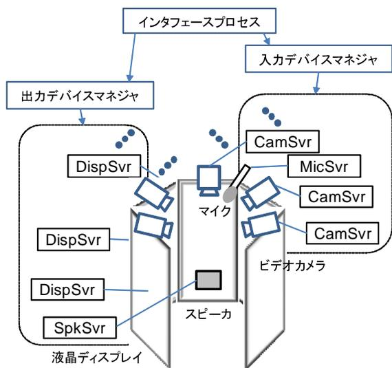
図 5: t-Room のシステム構成図
