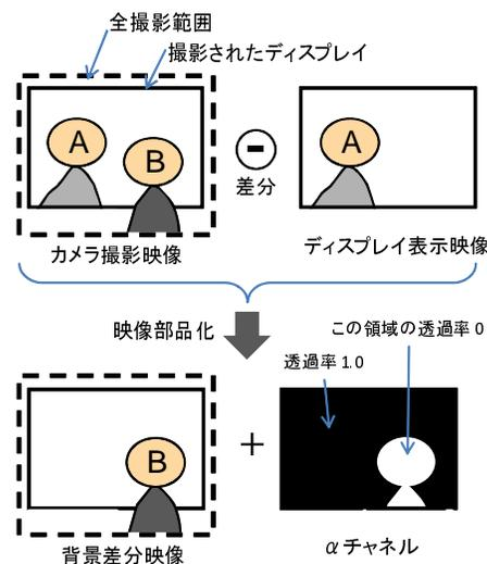
図 2: カメラ映像の部品化
