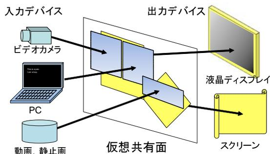
図3: 仮想共有面による入出力デバイスの抽象化
