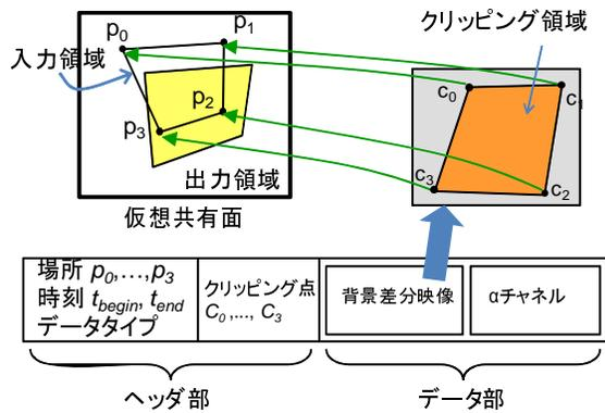
図 7: NZAM による Motion JPEG データの時空間コンテンツ化
