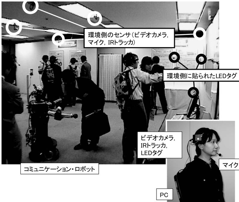
図3 センサ類とLEDタグの設置
