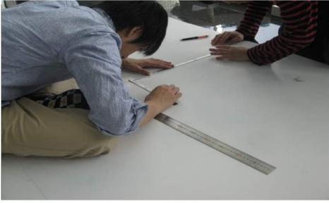
画用紙を長く繋ぎ合わせ設計図通りに印付けを行い切り出した型紙を作成
