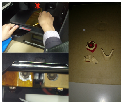
図 3.3 左上：カプトンテープ 左下：破損した部品 右：補修した部品
