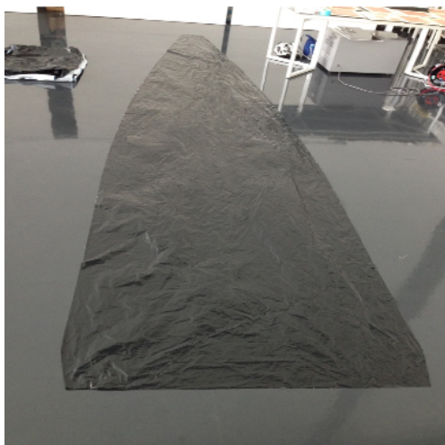
図 3.1.4 エアドーム本体の切り出し
