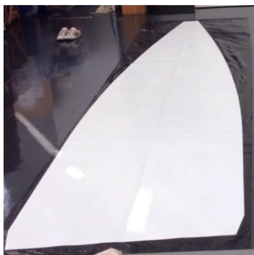
図 3.1.3 直径 5.6m エアードーム本体の型紙
