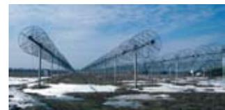
電波望遠鏡 UTR-2 のアンテナ列
