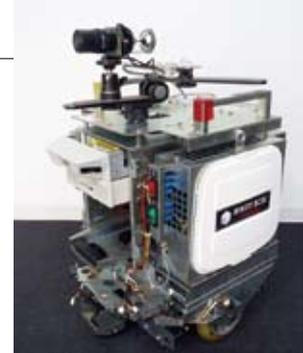
広視野画像取得装置を搭載した移動ロボット
