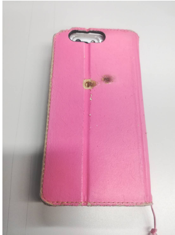
図 3.10 一部が焦げたスマートフォンのケース
