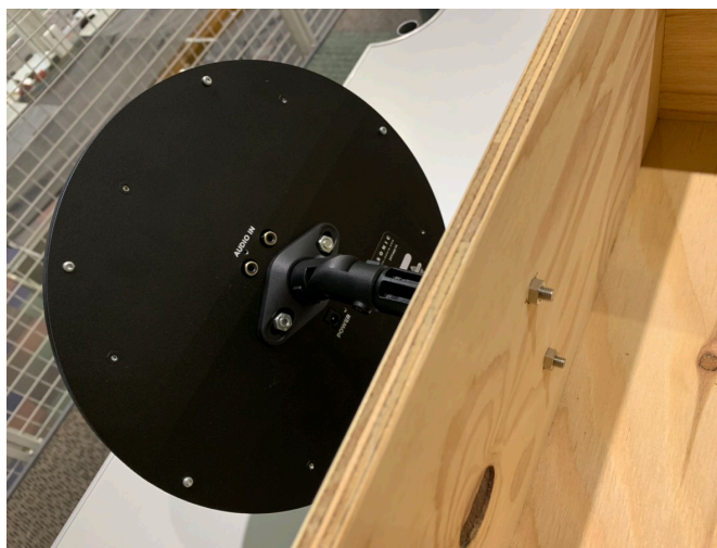
図 4.2 木の箱にスピーカーを固定した様子
