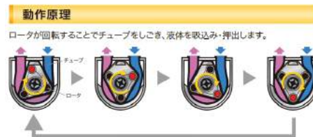
図 14: チューブポンプの原理
