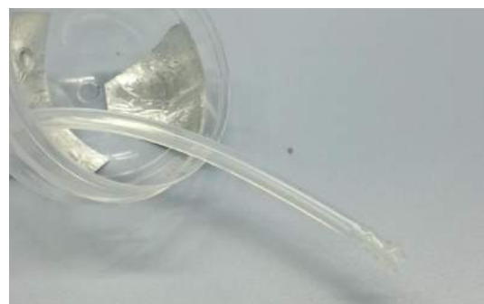
図 29: 外れにくくした空気抜き用のチューブ
