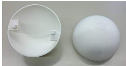
図 22: 凸ブロック付きのカプセル型パーツ
