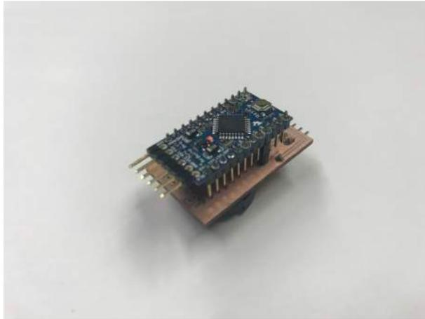
図 21 ArduinoProMini と専用基板
