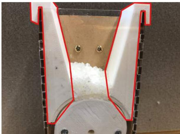
図 29 材料を誘導する追加パーツ (赤線に囲まれた部分)
