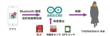
THERMONAVI は、Arduino と iOS アプリが連動して動作します。 iOS アプリと Arduino を Bluetooth 通信で連動し、アプリ内の地図上 で目的地の座標にピンを立てると Arduino に座標情報を送信します。 アプリから送信された座標情報を Arduino に接続されている BLE で受 信し、Arduino に接続されている GPS モジュールと地磁気センサによっ て得られる現在地の座標情報と向いている方角と受信した座標情報をも とに、目的地の方角を算出します。目的地の方角に対応する THERMONAVI に内蔵されているペルチェ素子の温度が変化し自分の 目的地の方角がわかるというものです。
