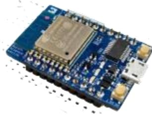
図 4 ESP-WROOM02 開発ボード
