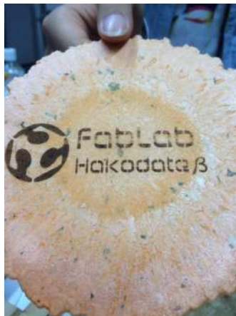
図 2.4 食品用レーザーカッターを用いて彫刻したお菓子
