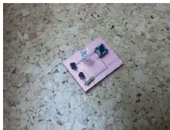
図 2.6 基板加工機を用いて制作した基板
