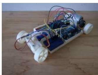
図 2.5 Arduino と 3D プリンターを用いて制作した車
