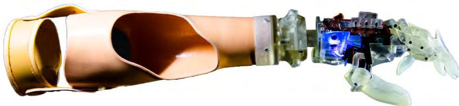
Fig.5 筋電義手「滯」
