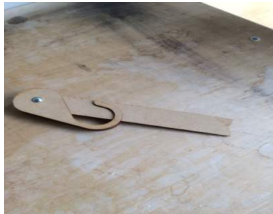
図 3.5 折りたたみ可能に改造した MDF ハンガー
