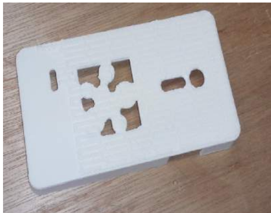
図 3.3 ラフトがへばり付いたしまった例
