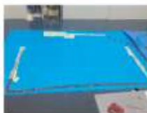
カーボン用紙とスポンジを貼り付ける Stick carbon papers and sponges
