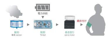
O2 センサを用いて酸素濃度を検知し、Adafruit Pro Trinket で制御して、サーボモータを動かします。これによってバンドが巻き取られ、締め付けられます。また、スタンドアローンにするために、電池駆動を実現しています。
