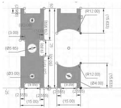
図 4.15 サーボモータ駆動パーツ
