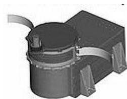
図 5.6 エネルギー粒子測定装置
