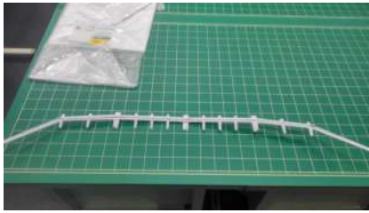
図 4.4 主翼の骨組み
