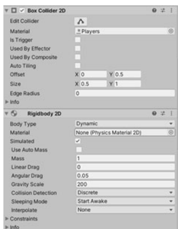
図 6.24 プレイヤーに付与した Box Collider 2D と Rigidbody 2D
