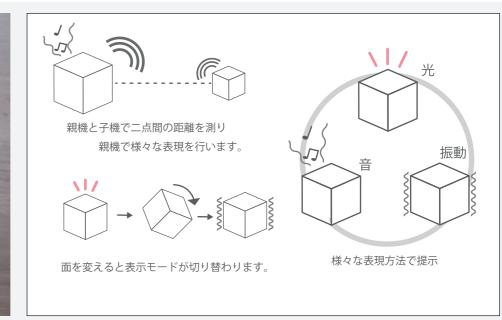
距離感という微妙な感覚を、視覚・聴覚・触覚などあらゆる感覚を用いて知覚しています。そんな複雑な感 覚をダイレクトに伝えてくれるボックス型の Elements を制作しました。二点間の Bluetooth 電波強度を 用いて距離感を検出し、それに応じて光・音・振動のパターンを表現します。6面それぞれに異なる表現が 備わっており、ジャイロセンサーによって面を切り替えると表現方法も切り替わる仕組みです。
