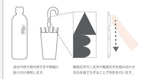
このタグは物体に張り付けて、触覚の情報をもとに個人の所用物を判別することを目的とした Elements です。具体的には、アルファベットの特徴を触覚的に表現した触覚文字を使用し、モノなどに貼り付けるこ とで物体に触覚的な情報付け加えます。タグを指でなぞることで視覚のみに頼らず触覚で自分の所有物であ ることを判別できます。
