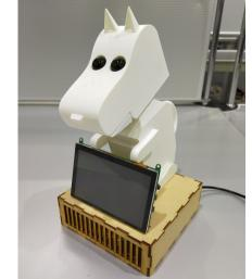
ロボットのコンセプトとして「チープでおもちゃらしいデザ インや動き」を掲げ、上記のようなデザインのロボットを 製作した。モデリングをFusion360で行い、そのデータ を3Dプリントしてロボットの筐体を作成した。ロボットの 表情変化にはRaspberry Piのタッチパネルと Processingのアニメーションを用いた。顔であるタッチ パネルをタッチすることで表情が変化しそれに合わせて モータを変化させるようにした。
