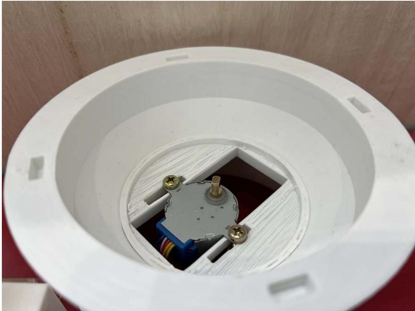
図 2.15 土台部にネジで固定したステッピングモータ
