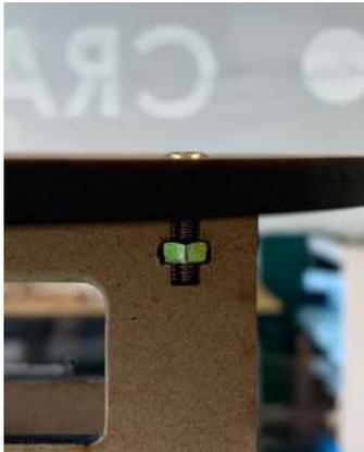
図 3.16 ナットを埋め込んだ際の実際の図
