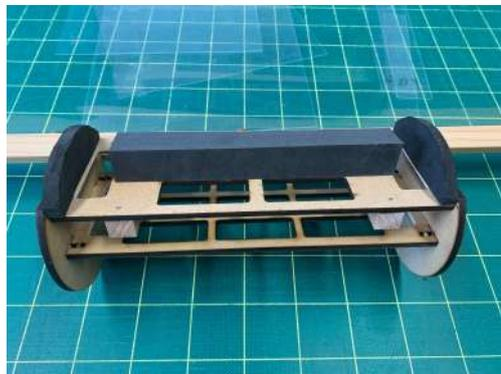
図 3.20 機体下部の衝撃吸収機構
