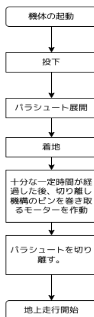
図 3.18 機体を投下させてから地上走行を始めるまでのフローチャート
