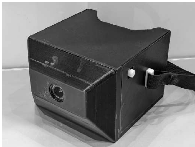
図 7.3 3D プリンタで出力した筐体
