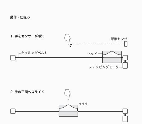
ステッピングモータに より回転を行なっている
