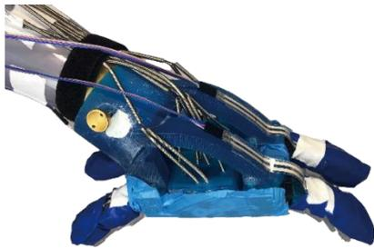
図 3.2.1 製作した筋電義手の外観
