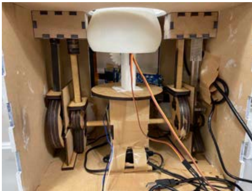
図 4.5 オートマタの内部機構
