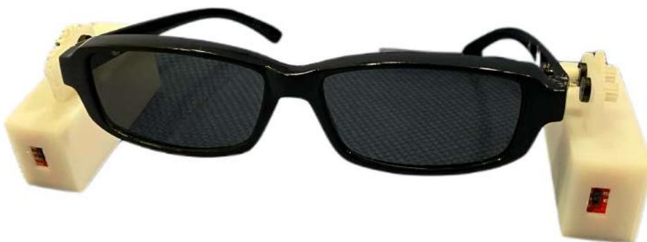
図 5.1 上方向障害物検知デバイス
