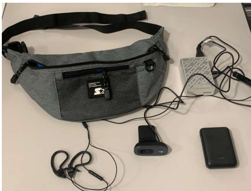
図 4.11 点字ブロックリーダー
