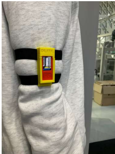
図 3.3 サーボモータによる通知を採用したプロトタイプ
