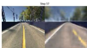
シミュレーション上で実際に観測した画像(左)とVAEにより再構成した画像(右)
