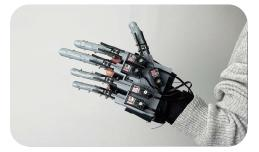
全指を欠損している人を対象にした、5 本指を独立して動かすことができる筋電義手を作製した。計測した筋電位に基づいたデータから機械学習によってモデルを作成し、それによってリアルタイムでデータの特徴パターンを識別して、動作させることを可能にした。
