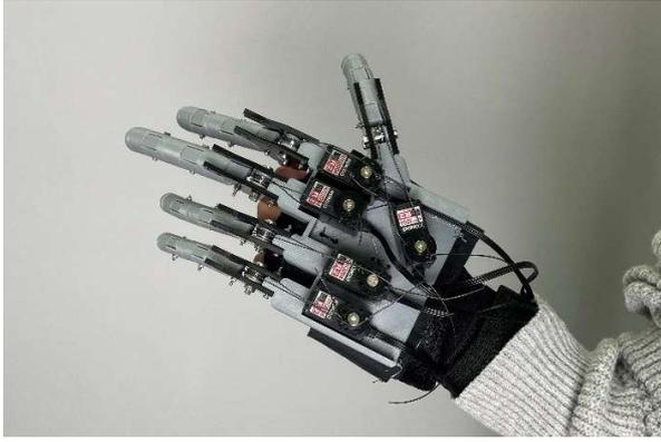
図1 5本指を独立に動かすことができる筋電義手
