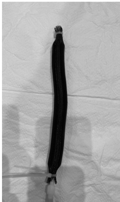
図 2.10 平常時の空気圧ゴム人工筋肉
