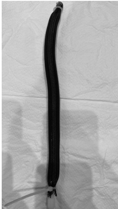
図 2.11 空気を注入されて伸長した空気圧ゴム人工筋肉
