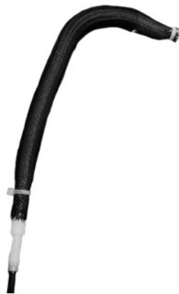
図 2.13 糸で固定されたことで片側に向かって曲がる空気圧ゴム人工筋肉
