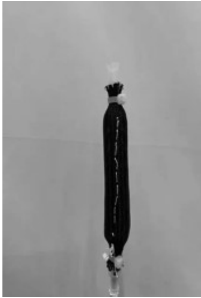
図 2.12 片側を糸で固定した空気圧ゴム人工筋肉
