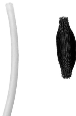
図 2.8 ゴムチューブ (左) と編組チューブ (右)
