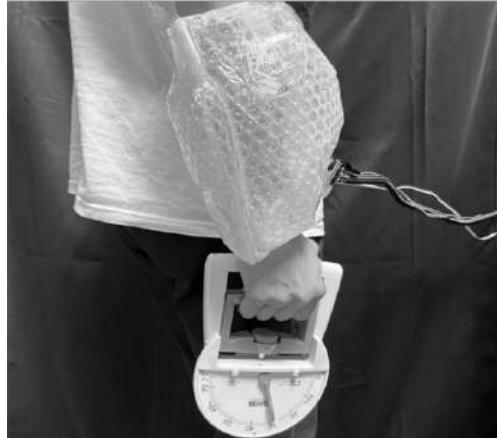
図 4.3 筋肉袋膨張後の握力測定の様子
