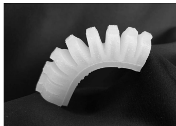
図 5.2 空気の圧力で動かす構造
