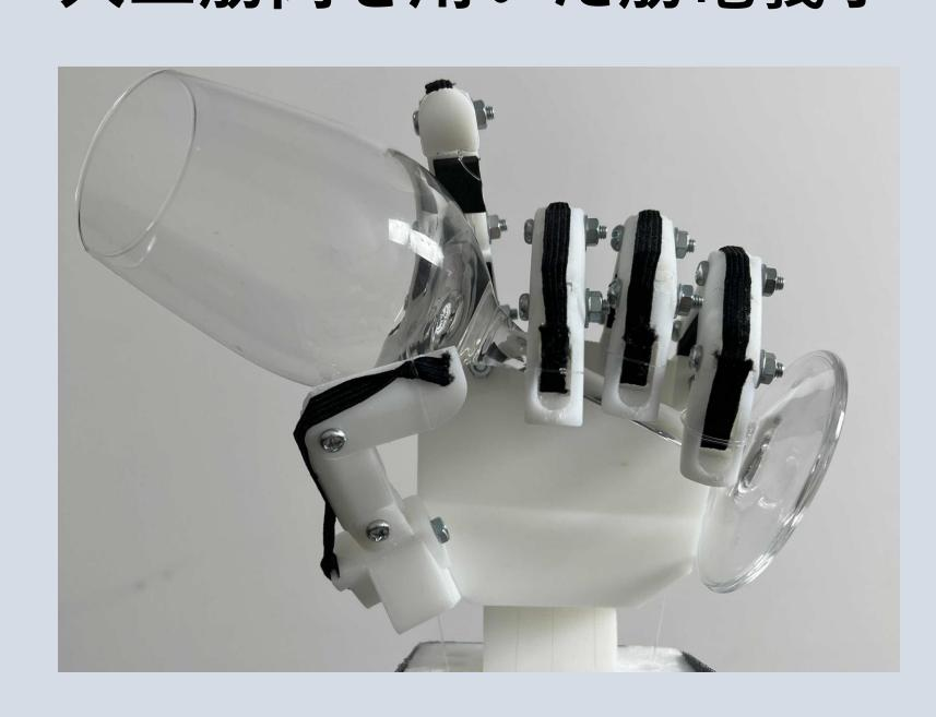
本グループでは、手首の欠損/不自由という障害を 抱える人を対象として、より柔軟な把持を精密に再 現したいと考えた。サーボモーターを用いた筋電義 手が一般的であるが角度制御であり、人の握る動作 を精密に再現するには複雑な制御が必要となってし まう。そこで圧縮空気を利用して柔軟かつ滑らかな 動きを実現でき、より人間の筋肉の動作に近い制御 が可能であるマッキベン型人工筋肉を使い、あらゆ る形状のものを把持できる筋電義手を作ることを目 的とした。
