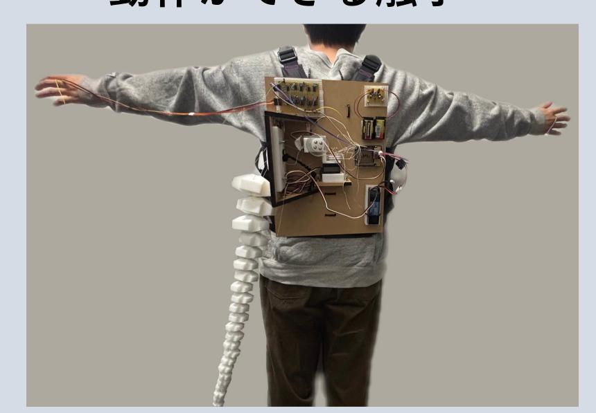
本グループでは、人間には存在しない動物の部位を つけることで今までできなかった動作ができないか と考えた。話し合った結果、柔軟さや器用さから 「触手」という特殊な部位に着目した。触手を人間 がつけることで新たな動作や感情表現の手段を提供 する可能性があると考えた。本研究では、触手が持 つ身体拡張の可能性に着目し、三次元的かつ直感的 な操作が可能な触手型デバイスの設計と、測定した 筋電位を用いた制御システムの開発に取り組んだ。
