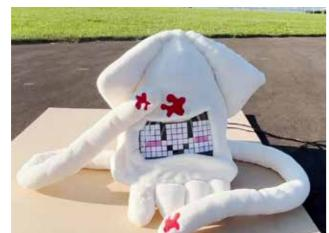
(1)エンタメロボ提案を行うデザイン班では、未来大らしいエンタメロボの提案、プロトタイプ・最終制作の外装制作、課外発表を行った。エンタメロボの提案では、マスコット分析とロボット分析を行い、開発するエンタメロボの見た目と機能を定義した。プロトタイプの外装制作では、提案したデザインをもとに既存のロボットに被せる外装を制作し、動く触腕を取り付けた。また、最終制作では、プラットフォームの大きさに合わせた外装を制作した。課外発表は、ヒューマンインタフェース学会、日本デザイン学会で発表を行った。
