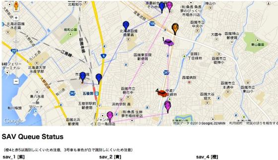
図6 フィージビリティ実験中のSAV状態モニタ画面
