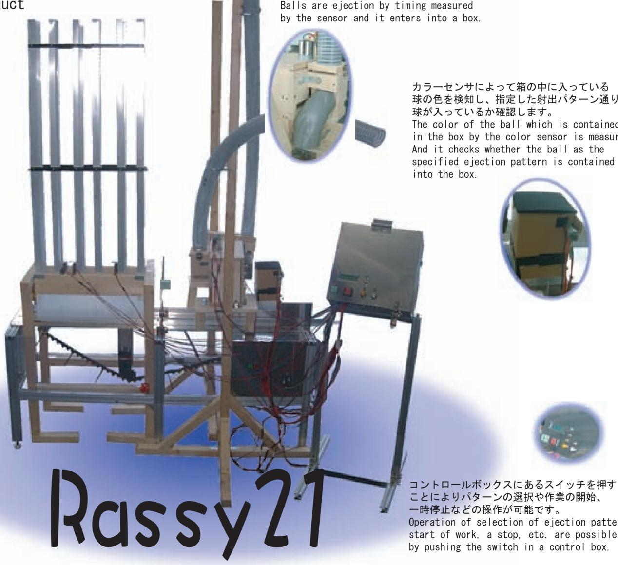
カラーセンサによって箱の中に入っている 球の色を検知し、指定した射出パターン通りの 球が入っているか確認します。 The color of the ball which is contained in the box by the color sensor is measured. And it checks whether the ball as the specified ejection pattern is contained
