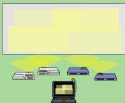
現在の各プロジェクトからの投影状態を認識するために、各プロジェクトの投影するテストパターンの形状をいくつかのスレーブ側に接続された複数のカメラから撮影し、個々のプロジェクトの形状と色の情報をネットワークを介して自動的に収集する。複数台のカメラで撮影を行う際には、正確なデータを得るために、すべてのカメラにおいて同等の条件で撮影する必要がある。そのためにはスレーブ側のカメラをマスター側からプログラムを介して制御しなければならない。そこで我々はカメラ制御プログラムを作成し、マスター側からスレーブ側のカメラを制御することを実現した。
